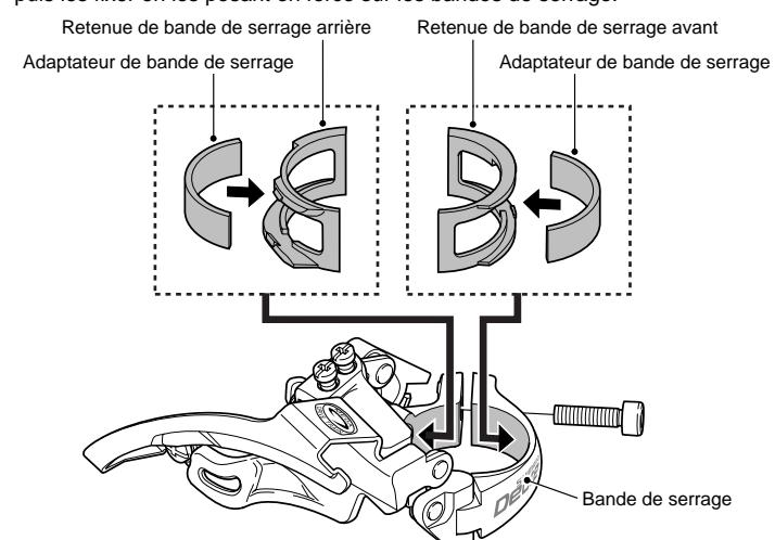
**Remarque:** Les adaptateurs de bande de serrage et les retenues de bande de serrage avant et arrière sont disponibles en deux tailles: taille S (28,6 mm de diamètre) et taille M (31,8 mm de diamètre).
