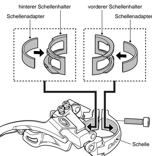
**Hinweis:** Die Schellenadapter und die vorderen und hinteren Schellenhalter sind in zwei Größen erhältlich: Größe S (für Durchmesser 28,6 mm) und Größe M (für Durchmesser 31,8 mm).
